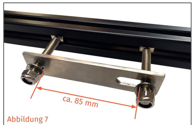
3. Bevor du alle Muttern festziehst, überzeuge dich davon, dass dein Dachzelt mittig auf dem Dach deines Fahrzeuges platziert ist und dass die Montagepunkte (soweit möglich) symmetrisch zu den Eckpunkten des Dachzeltes positioniert sind.
